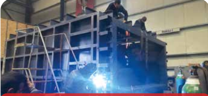
Aluminyum Ergitme Fırın İmalatı Aluminium Melting Furnace Manufacturing
